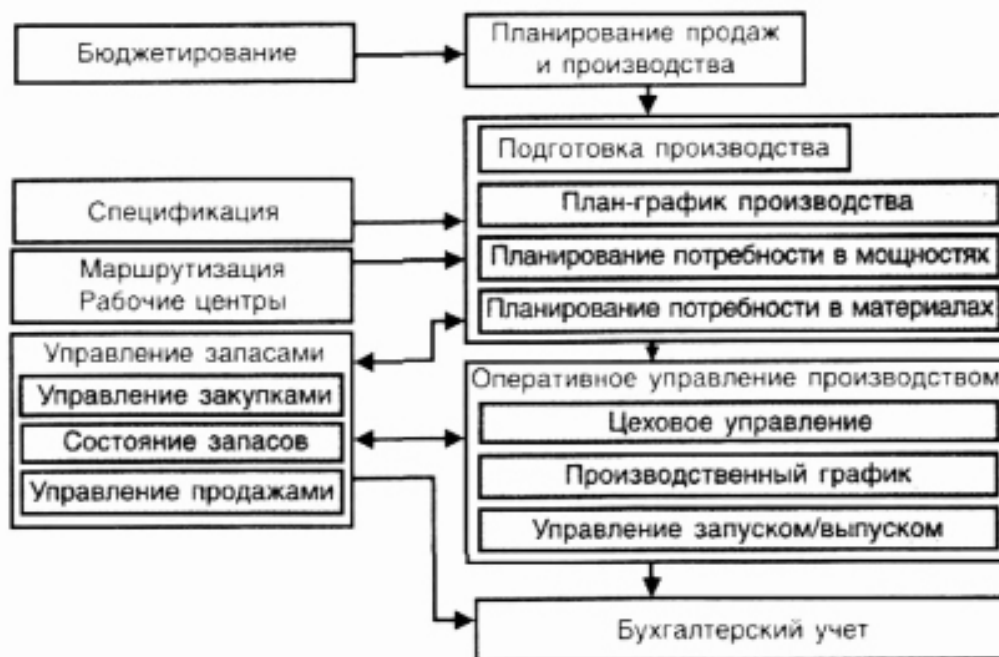
Рисунок 5 – Схема информационных потоков в производственных ИС учетного типа
